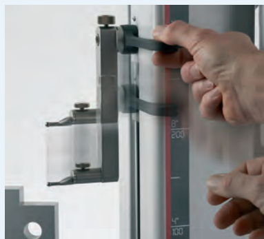
图示 1. 单手将测量滑车向测量方向移动
